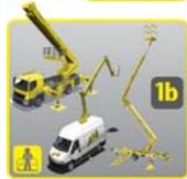
**Estática de brazo (1b):** Plataformas de brazo autopropulsadas con estabilizadores, plataformas sobre remolque, plataformas montadas sobre camión.
