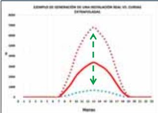
Gráfico que muestra una curva de generación real (línea roja) y una curva de potencia pico extrapolada (línea verde) sobre un eje de horas. Una flecha verde indica la extrapolación de la potencia pico.
