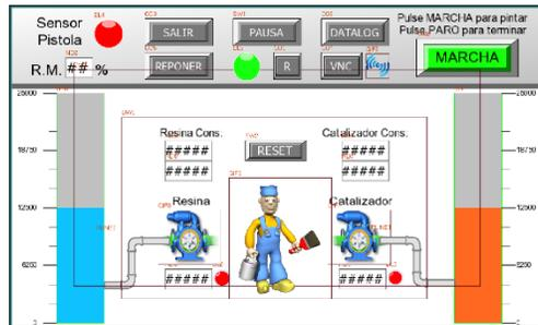
Este tipo de equipos se utiliza para la aplicación de pinturas de dos componentes, que se mezclan justo antes de la aplicación para obtener un acabado de alta calidad. Este sistema consta de varios componentes, que incluyen pistola de pulverización automática o manual, una unidad de mezcla y dosificación, una bomba de alimentación de aire y un controlador electrónico.
